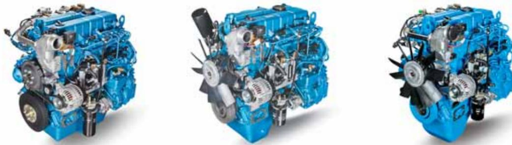
4-цилиндровые дизельные двигатели размерности DхS=105х128 мм, рабочим объемом 4,43 л, 4-тактные, рядные, с жидкостной системой охлаждения, турбонаддувом и охлаждением наддувочного воздуха в теплообменнике типа "воздух-воздух", установленном на изделиях.
