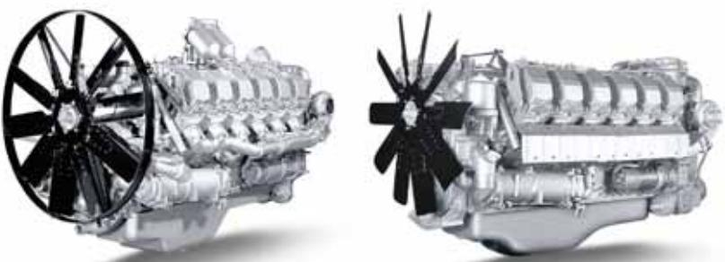
12-цилиндровые дизельные двигатели размерности DxS=140x140 мм, рабочим объемом 25,86 л, 4-тактные, с V-образным расположением цилиндров, турбонаддувом, непосредственным впрыском топлива, жидкостным охлаждением и охлаждением наддувочного воздуха.
