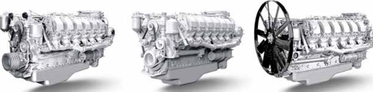
12-цилиндровые дизельные двигатели размерности DхS=140x140 мм, рабочим объемом 25,86 л, 4-тактные, с V-образным расположением цилиндров, турбонаддувом, непосредственным впрыском топлива, жидкостным охлаждением и охлаждением наддувочного воздуха.
