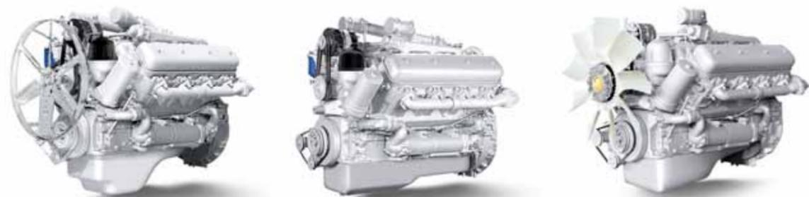
8-цилиндровые дизельные двигатели размерности DхS=130х140 мм, рабочим объемом 14,86 л, 4-тактные, с V-образным расположением цилиндров, турбонаддувом, непосредственным впрыском топлива, жидкостным охлаждением. Выполнены под установку охладителя наддувочного воздуха на изделиях.
