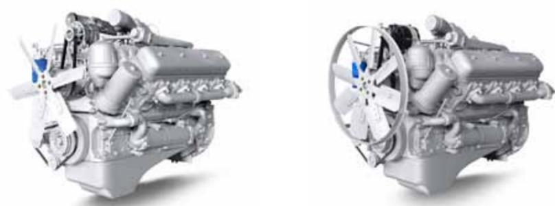
8-цилиндровые дизельные двигатели размерности DхS=130х140 мм, рабочим объемом 14,86 л, 4-тактные, с V-образным расположением цилиндров, турбонаддувом, непосредственным впрыском топлива, жидкостным охлаждением. Выполнены под установку охладителя наддувочного воздуха на изделиях.
