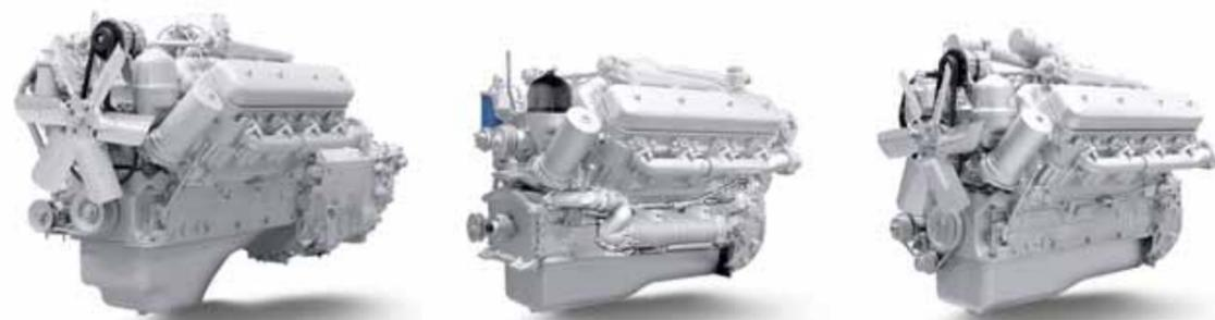
8-цилиндровые дизельные двигатели размерности DхS=130х140 мм, рабочим объемом 14,86 л, 4-тактные, с V-образным расположением цилиндров, турбонаддувом, непосредственным впрыском топлива, жидкостным охлаждением.
