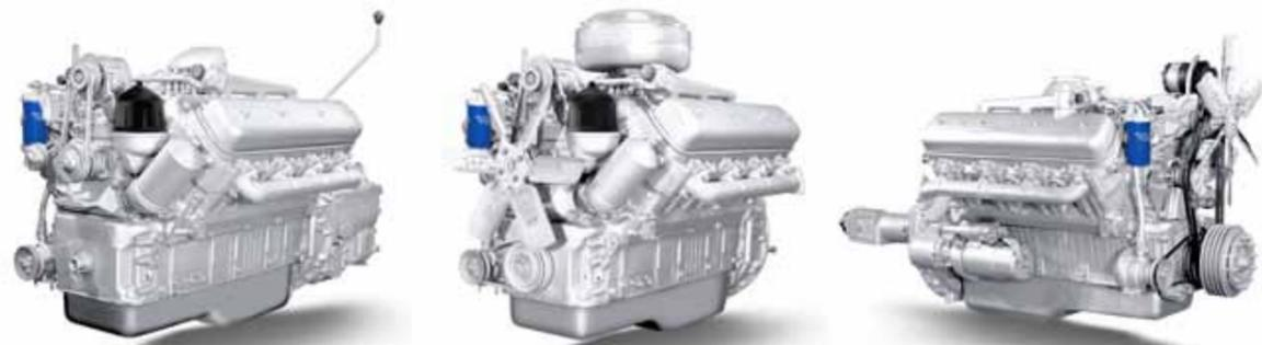
8-цилиндровые дизельные двигатели размерности DхS=130х140 мм, рабочим объемом 14,86 л, 4-тактные, с V-образным расположением цилиндров, непосредственным впрыском топлива, жидкостным охлаждением (без турбонаддува).
