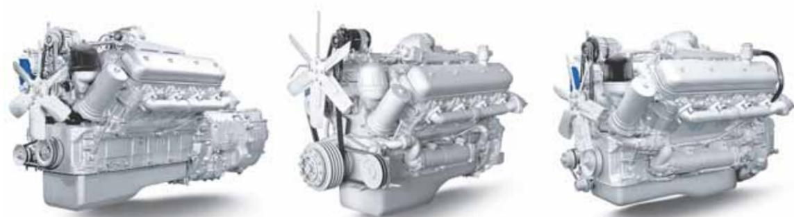
8-цилиндровые дизельные двигатели размерности DхS=130х140 мм, рабочим объемом 14,86 л, 4-тактные, с V-образным расположением цилиндров, турбонаддувом, непосредственным впрыском топлива, жидкостным охлаждением.
