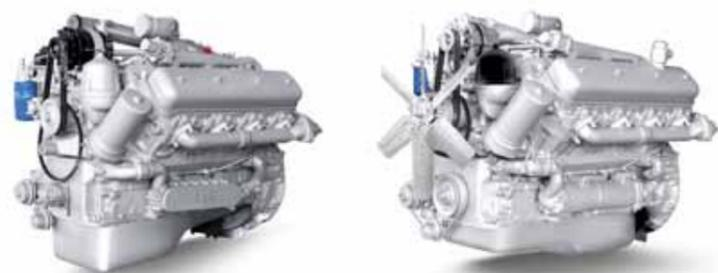
8-цилиндровые дизельные двигатели размерности DхS=130х140 мм, рабочим объемом 14,86 л, 4-тактные, с V-образным расположением цилиндров, турбонаддувом, непосредственным впрыском топлива, жидкостным охлаждением. Выполнены под установку охладителя наддувочного воздуха на изделиях.
