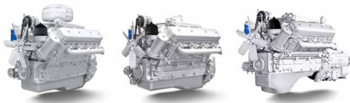
8-цилиндровые дизельные двигатели размерности DхS=130х140 мм, рабочим объемом 14,86 л, 4-тактные, с V-образным расположением цилиндров, непосредственным впрыском топлива, жидкостным охлаждением (без турбонаддува).
