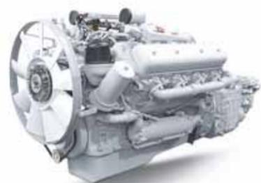
8-цилиндровые дизельные двигатели размерности DхS=130х140 мм, рабочим объемом 14,85 л; 4-тактные, с V-образным расположением цилиндров, турбонаддувом, непосредственным впрыском топлива, жидкостным охлаждением. Выполнены под установку охладителя наддувочного воздуха типа "воздух-воздух" на изделиях. Уровень шума не более 96 дБ(А).
