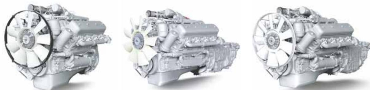
8-цилиндровые дизельные двигатели размерности DxS=130x140 мм, рабочим объемом 14,86 л, 4-тактные, с V-образным расположением цилиндров, турбонаддувом, непосредственным впрыском топлива, жидкостным охлаждением. Выполнены под установку охладителя наддувочного воздуха типа "воздух-воздух" на изделиях.
